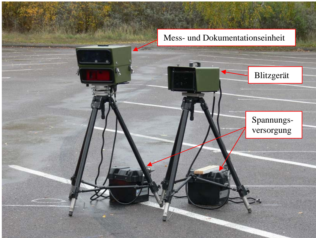
Abbildung 1: Komponenten des Messsystems PoliScan speed
